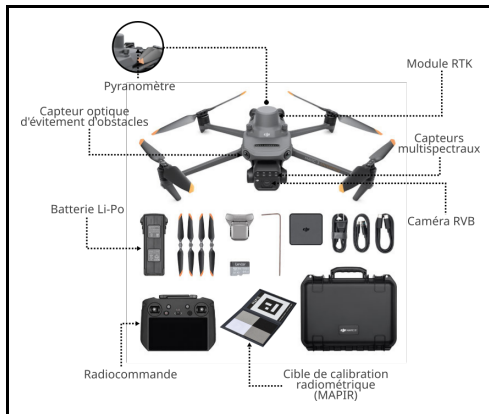
Fig. 1.1. Mavic 3M RTK et ses accessoires, tel que vendu dans ses versions les plus courantes.
